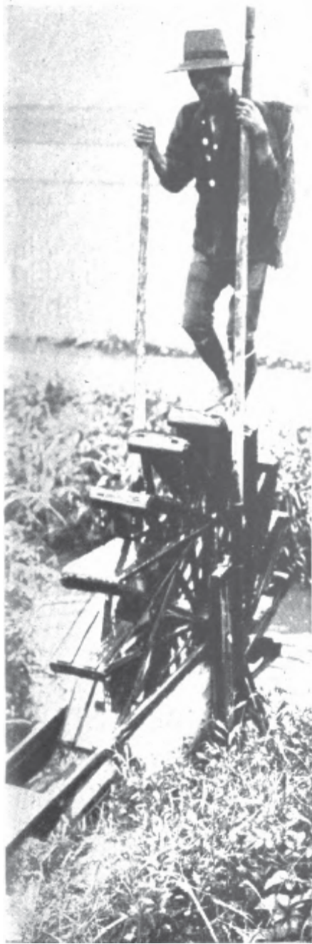
原始的な水車がいまだに水田の灌漑に使用されている。
